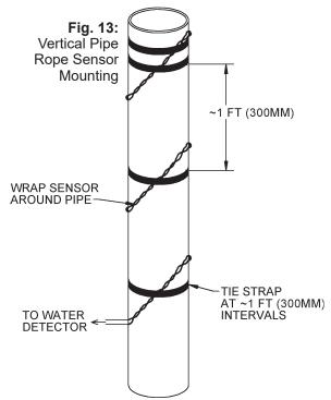
MOUNT AROUND PIPE UNDER INSULATION
